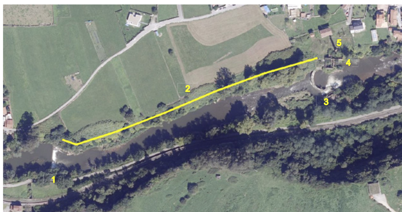
Ortofoto del conjunto de la central actualmente (Mapas Cantabria). 1-Azud, 2-Canal derivación subterráneo 3-Presa, 4-Edificios, 5-Chimenea.
